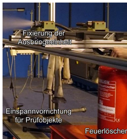
Abbildung 11: Einbau eines Feuerlöschers in die Einspannvorrichtung der PDA
