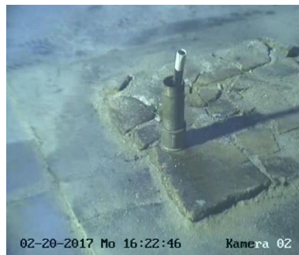
Abbildung 10: Aufbau für den Abbrand von Bengalischen Feuerwerkskörpern
