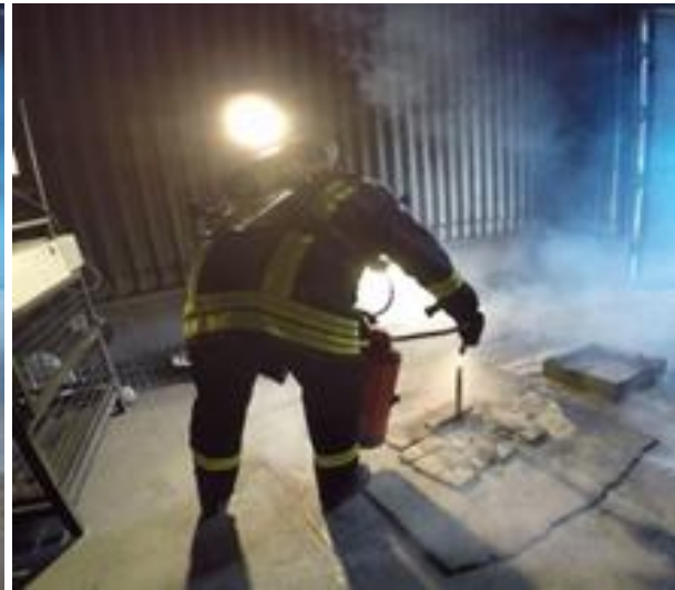
Direkte Beaufschlagung mit Wassernebel
