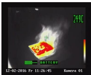
Ende des Löschangriffs (Feuerlöscher FLN W 6 WNA leer)
