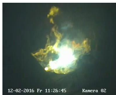
Ende des Löschangriffs (Feuerlöscher FLN W 6 WNA leer)
