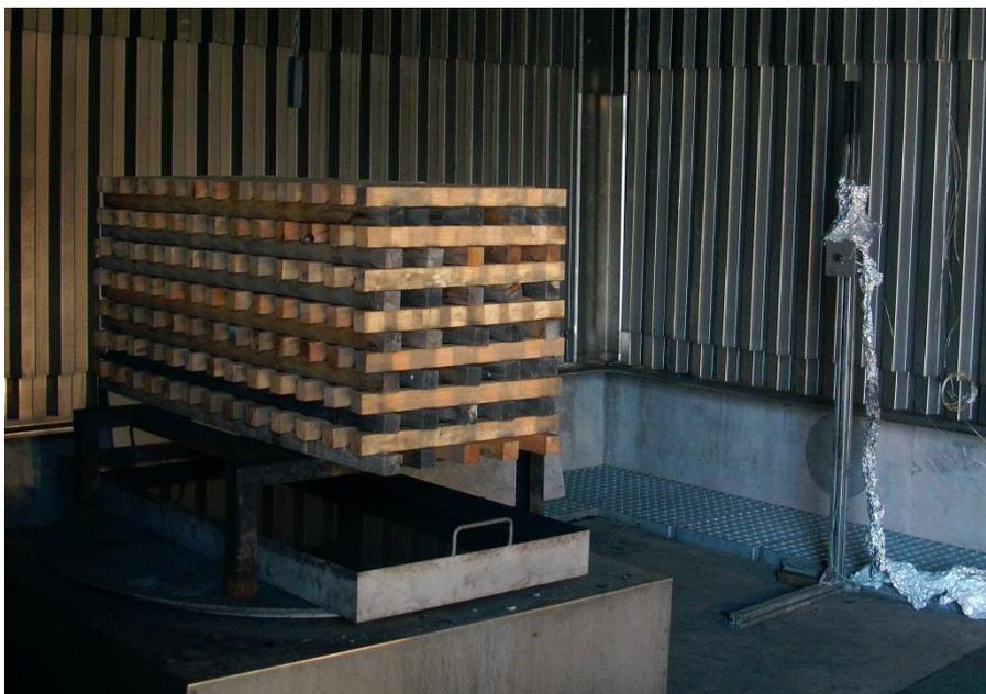
**Bild 4.3:** Anordnung von Radiometer 1 in einem Versuch mit einer Krippe 13A
