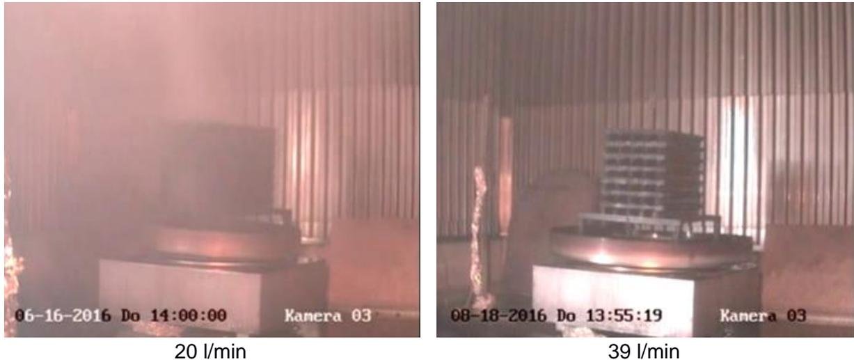
**Bild 5.6:** Normholzkippe 8A während Löschwasseraufbringung nach 2 min in Versuch 12 (links) und in Versuch 16 (rechts)
