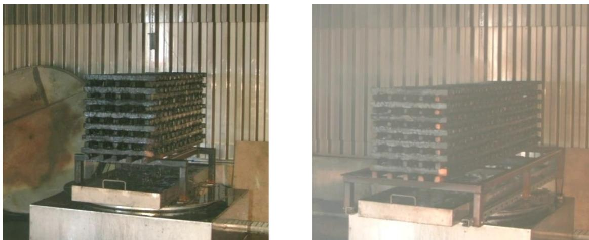
**Bild 5.18:** Krippe 13A (links) und Krippe 21A (rechts) nach Beendigung der Löschwasseraufbringung mit Düse C
