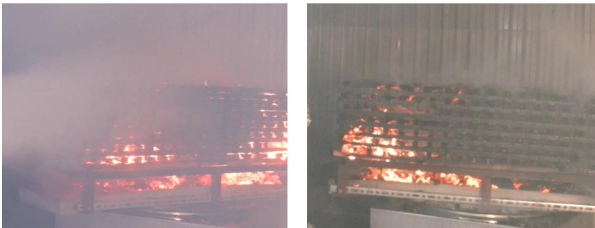
**Bild 5.14:** Krippe 21A+ nach 4 min Löschdauer (links) und 1 min nach Beendigung der Löschung (rechts)
