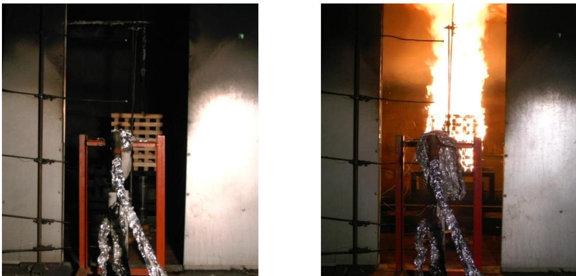
**Bild 3.3:** Versuchsaufbau: Holzkrippe 8A und Hochdruck-Löschdüse vor Versuchsbeginn (links), Holzkrippe in der Vollbrandphase (rechts)
