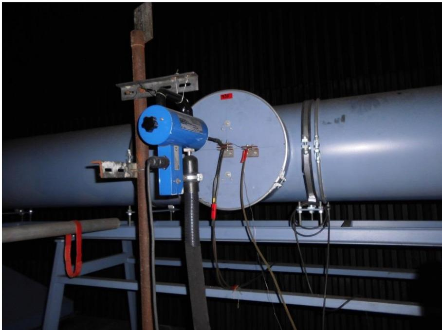
**Bild 3.6:** Beheizte Probenahmesonde für die FTIR-Messung am Messstutzen des Abgasrohres
