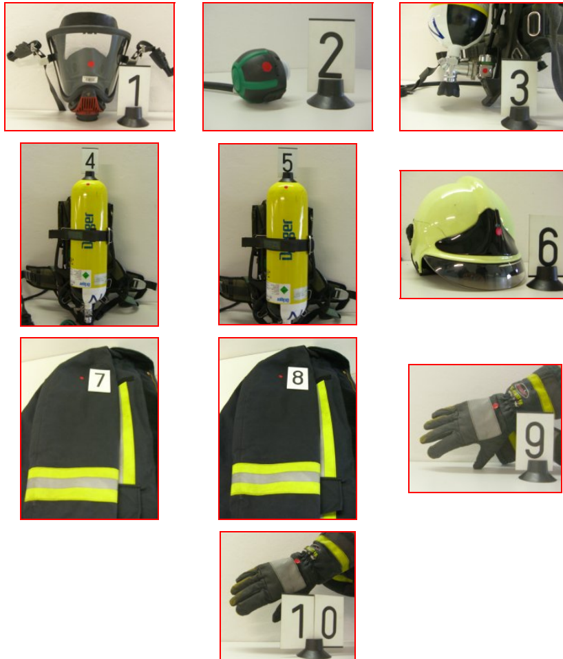
Bild 14: Messstellen an den Komponenten der PSA
