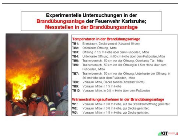
Bild 29: Messstellen in der Brandübungsanlage
