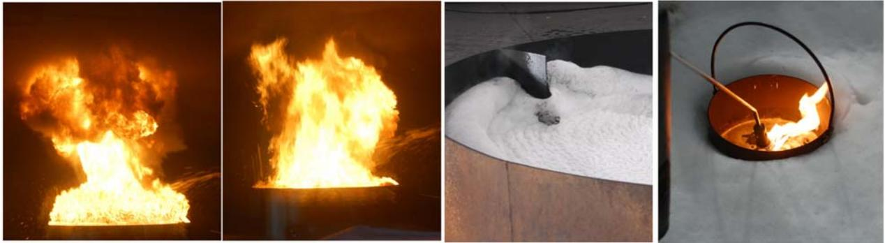
**Abbildung 31: Löschergebnis bei AFFF-Schaum**
