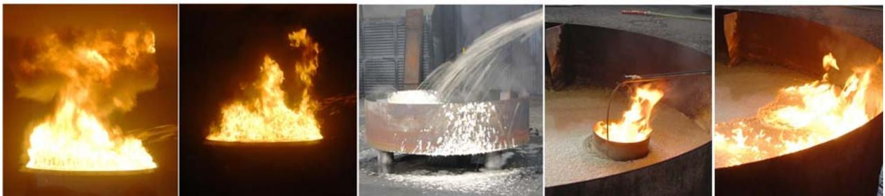
**Abbildung 30: Löschergebnis bei Fluorproteinschaum**
