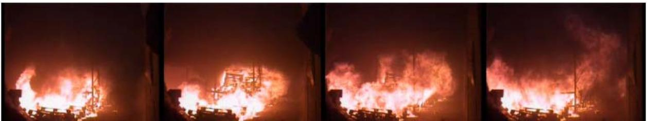
Abbildung 8: Bilder aus dem Videoclip der Pulsationen im Runehamar-Tunnel nach [Kim 2006]
